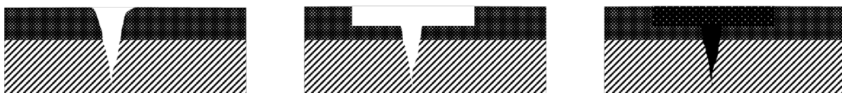
Rys. 4.8.1.1. Schemat wypełniania pęknięć metodą pasmową
